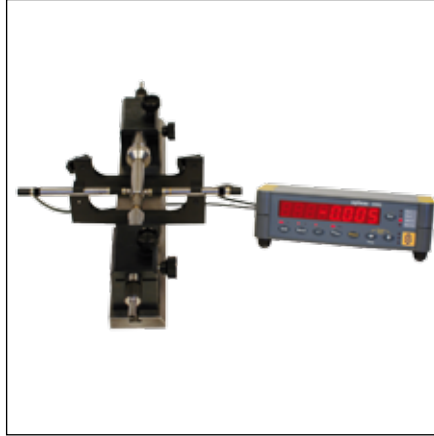
Sonda P5 conectada a una unidad D80S midiendo el diámetro externo de un eje
