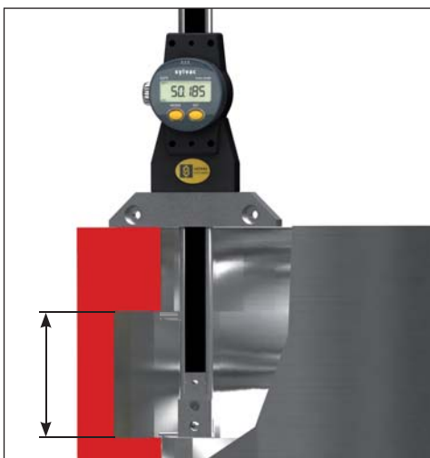
Medida de una altura de ranuras mediante el palpador de Ø4 ref. 805.6103 dentro de un eje.
