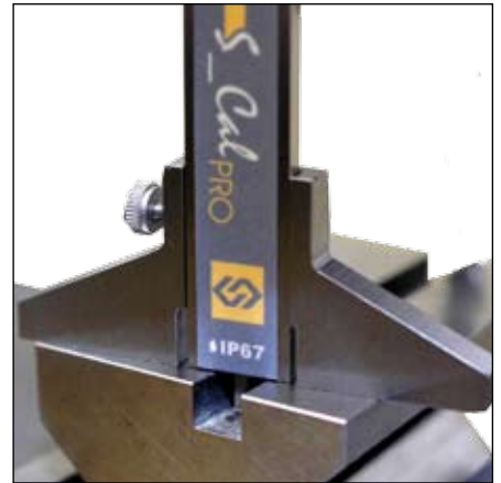
Medición de profundidad
