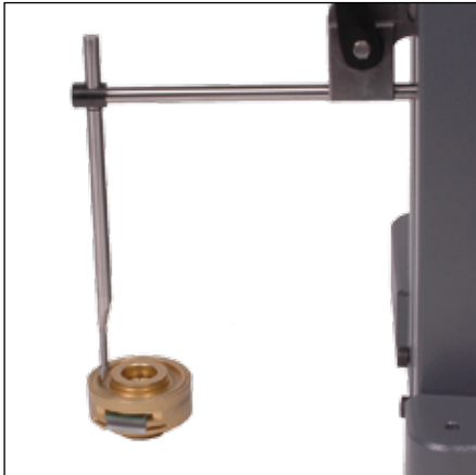
Mediciones profundas con accesorios 930.2108 y 930.2105
