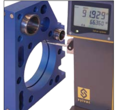
Mediciones internas con palpador con bola de rubí Ø 3 mm, 930.2101 (estándar)
