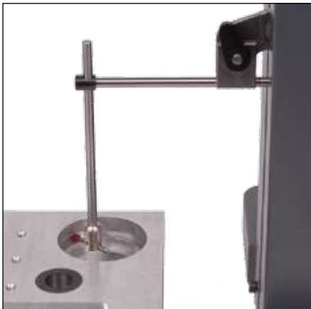
Medidas internas del surco con accesorios 930.2108, 930.2210 y 905.2207
