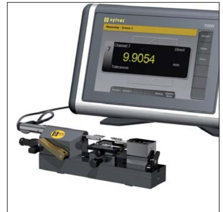
Medida con banco PS17. Scanning automático de los instrumentos conectado y detección de medida con el fin de mostrar el canal adecuado.
